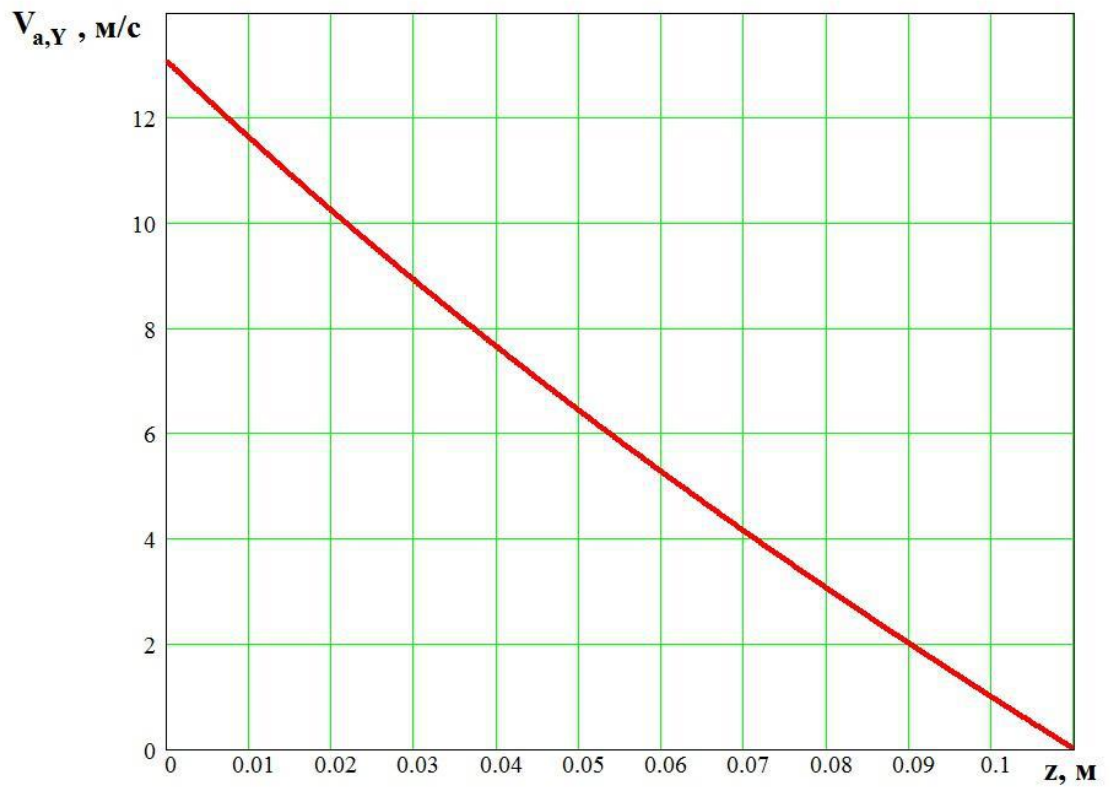
Рис. 4.4. Распределение окружных скоростей воздуха в камере разрыхлителя-очистителя CL-P ( n = 500 \text{ мин}^{-1} , R_B = 0,25 \text{ м} , h_k = 0,1 \text{ м} )
