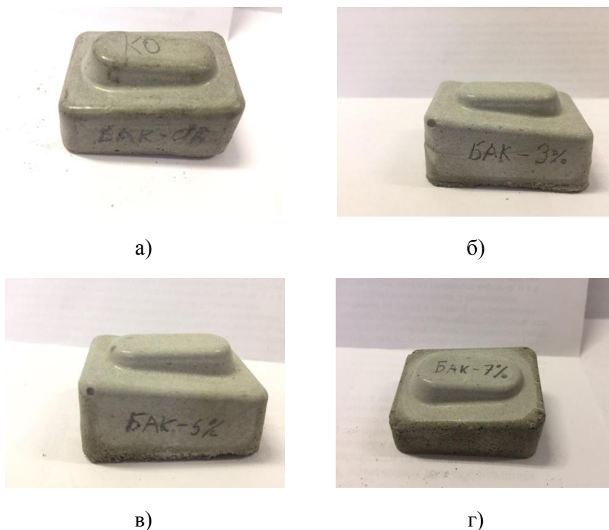
Рис.2. Образцы мелкозернистого бетона с добавкой препарата «Бакцид»: а) контрольный образец; б) содержание препарата 3%; в) содержание препарата 5%; г) содержание препарата 7%;
