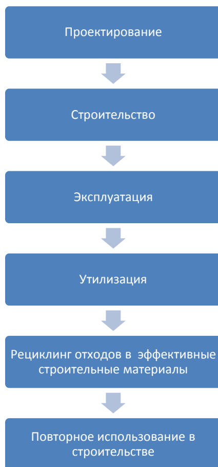
Рис. 1. Концепция безотходного строительства с применением рециклируемых материалов
