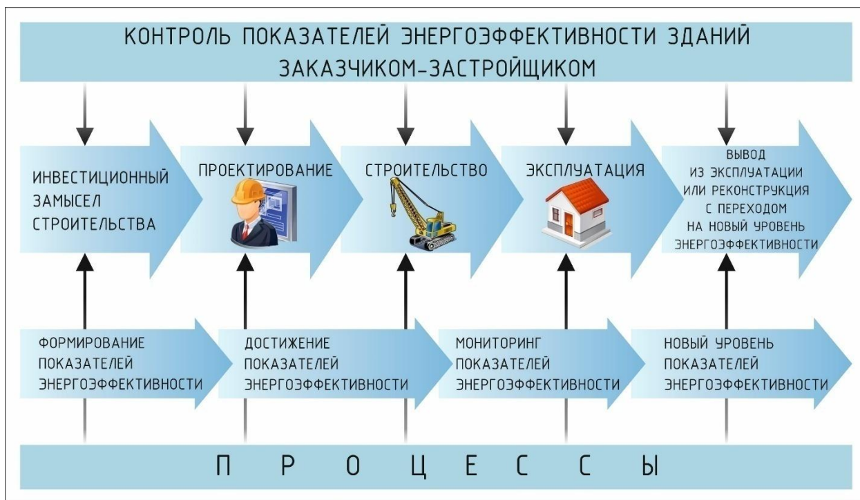
Рис. 2. Процессы жизненного цикла энергоэффективного здания
