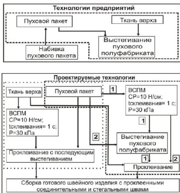
Рисунок 8. Схема технологии получения ниточно-клеевых соединений с пониженной проницаемостью для ППС
