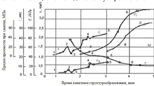
Рис. 3. Кинетика структурообразования шлакощелочного вяжущего: v - фазовая скорость, км/с; f p - резонансная частота, Гц; v , - скорость ультразвука, км/с; t - длительность фронта, мкс; R - предел прочности арболита при сжатии, МПа
