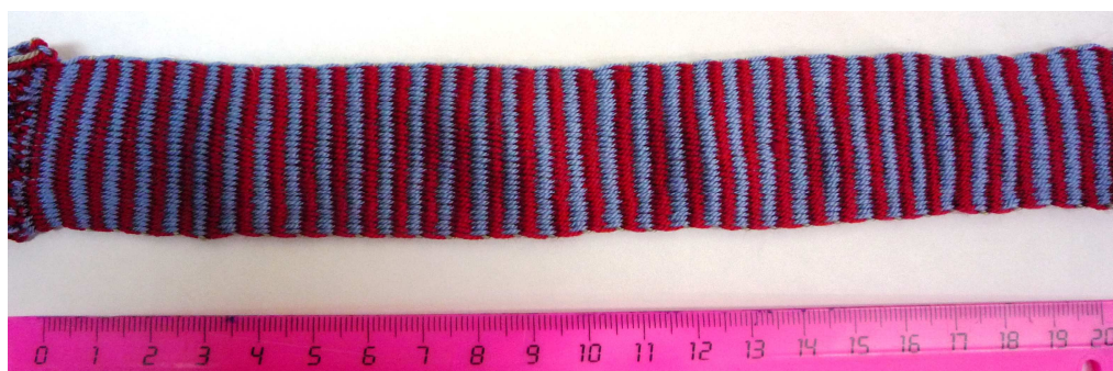
Рисунок 3.3 – Тканый образец полотняного переплетения
