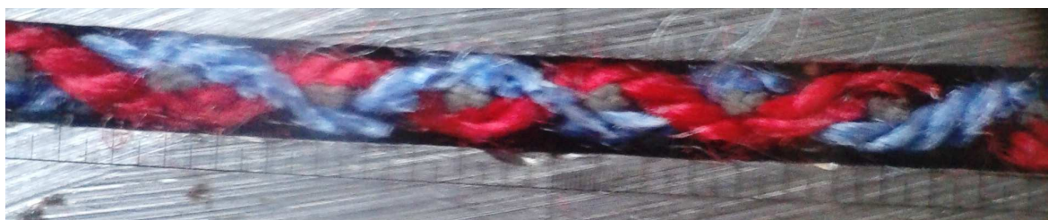
Рисунок 3.6 – Разрез триаксиальной ткани вдоль основы
