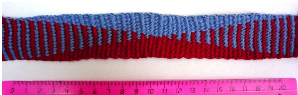
Рисунок 3.4 – Тканый образец триаксиальной ткани
