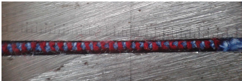
Рисунок 3.9 – Разрез трехосной ткани вдоль утка между уточинами
