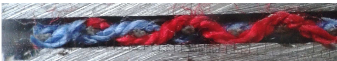
Рисунок 3.5 – Разрез триаксиальной ткани вдоль основы
