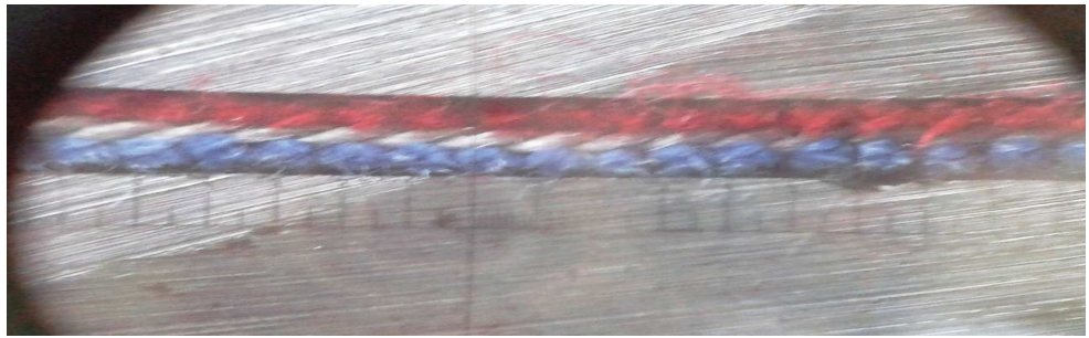
Рисунок 3.8 – Разрез триаксиальной ткани вдоль утка
