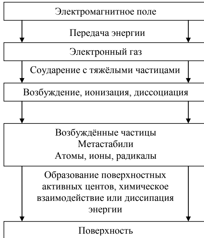
Рисунок 1.3. Схема процессов активации материалов в плазме низкого давления
