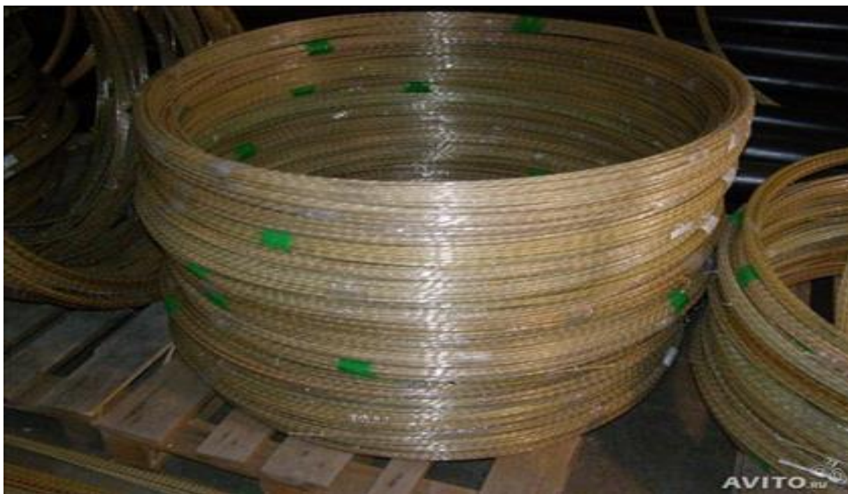
Рисунок 24 – Транспортировка композитной арматуры
