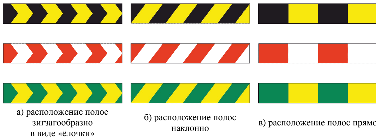
Рис. П 4. Примеры расположения полос сигнального и контрастного цветов на сигнальной разметке
