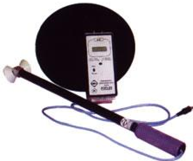
Рис. 1.3. ИЭП-05. Измеритель переменных электрических полей
